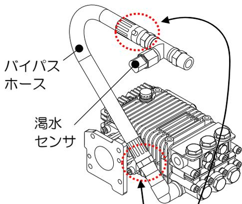
メンテナンス時は、この部分のツバ付きナットをはずしてください。組付け後、水漏れが無いことを確認してください。故障する恐れがあります。
