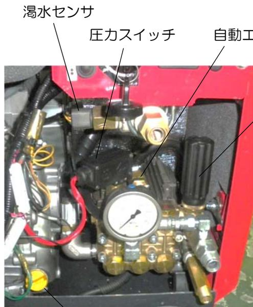
湯水センサ 圧カスイッチ 自動エア抜き
