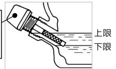
お買い上げいただいた高圧洗浄機のエンジンオイルは工場出荷時に給油済みです。運転前に必ず油量を確認し、不足の場合は、SE 級以上のガソリンエンジンオイルを口元まで補給してください。
