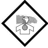
排気ガス中毒防止の為、室内、トンネル内、船倉、タンク内、テントなど換気の悪い所では使用しないでください。
